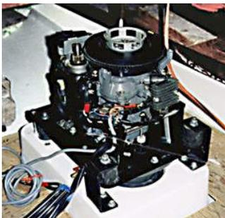
Der Motor wird dann mit dem großen Dichtungsring in das Motorfundament eingesetzt. Danach installiert man den Schalthebel, den Schaltbowdenzug, Treibstofftank mit Benzinfilter, Motorraumlüfter, die Motorelektrik, den Kühlwasseranschluss mit Absperrhahn und Entlüftungsventil sowie den Abgasschlauch.
