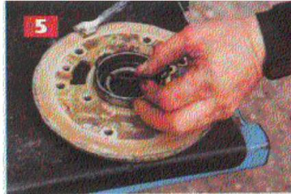
5 Säubern Sie die Ring Nut und entfernen Sie den alten 'O' Ring
